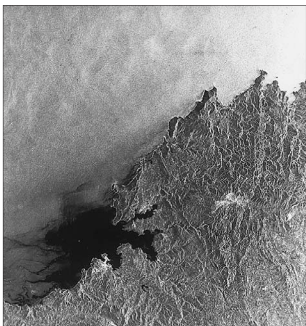
Nappe de pétrole vue par le satellite ERS 1 . Image du SAR d' ERS 1 reçue le 13 décembre 1992 et couvrant 95 km x 95 km sur la côte espagnole, près de La Corogne. La zone sombre sur la partie ouest du littoral correspond à la marée noire provenant du naufrage du pétrolier Aegean Sea (3 décembre 1992). Les liquides huileux ayant pour effet de lisser la surface de la mer, la présence d'une nappe de pétrole se traduit par une diminution du signal rétrodiffusé. (© ESA)
